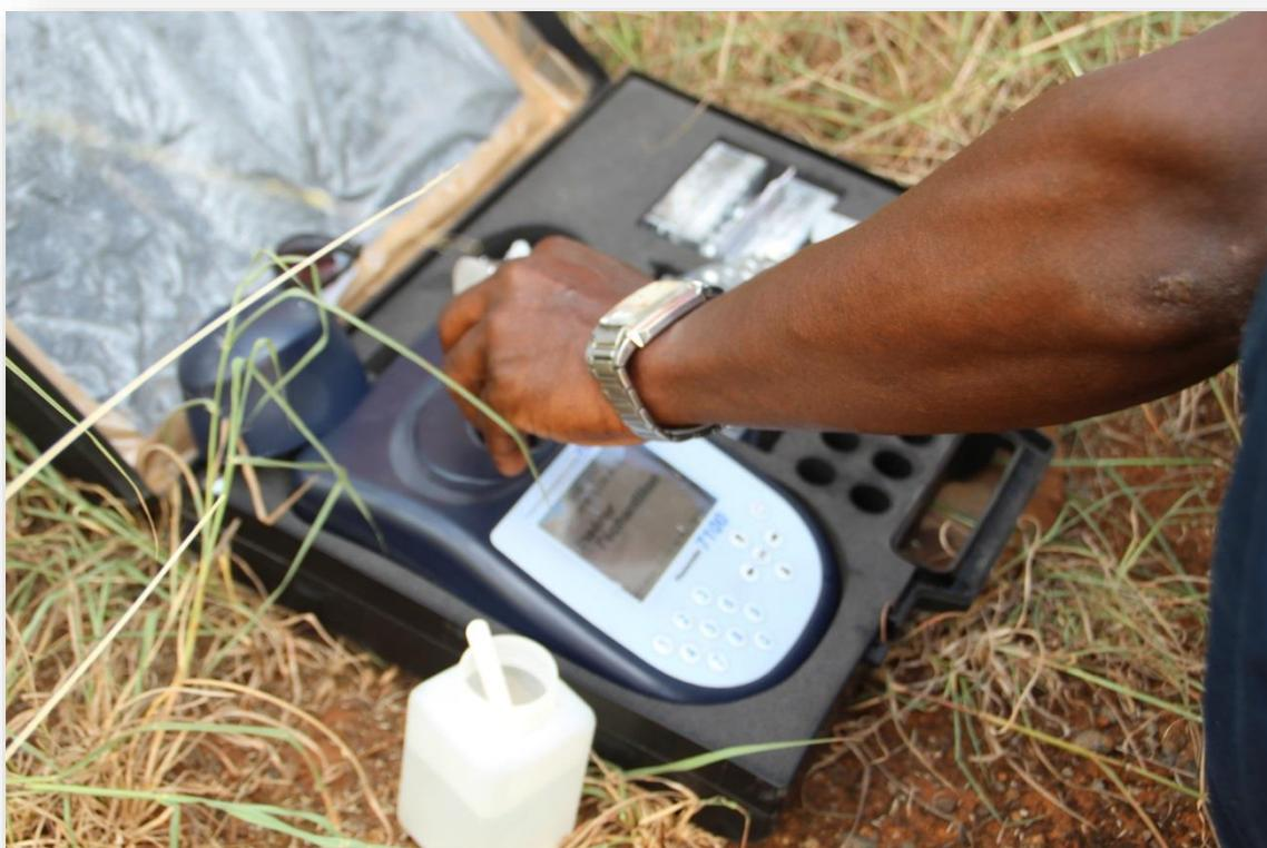
*Analyses terrain – mesure du chlore*
