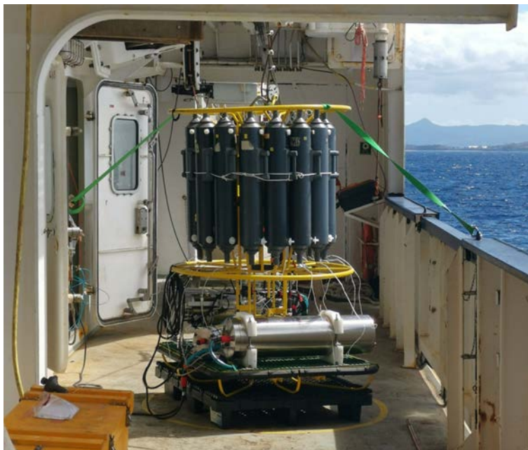
Figure 12 : CTD-Rosette (instrument de mesures in situ et de prélèvements de l'eau de mer) déployée à 10 reprises lors de Mayobs 4 jusqu'à 3500m de profondeur. 16 bouteilles de 8 litres sont prélevées à chaque profil. © IFREMER, REVOSIMA
