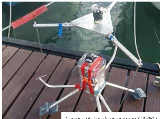
Caméra rotative du programme STAVIRO
